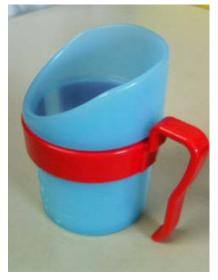
実はこれは、介護用品のひとつである。首の関節の怪我や障害などで、飲み物を飲むときに首を曲げることが困難か不可能であるか、あるいは苦痛である人がいる。その人たちが普通のコップを使うと、唇に触れるのと反対側のコップの縁が鼻にぶつかり、そのためにコップを傾かせる角度が不十分で内容物を飲み干せないので、このコップは、使用者の鼻がコップの縁に当たらないように、コップの向こう側の縁を斜めに切り落としている。つまりこのコップは、そうした一般的でないある目的に照らせば、ちゃんと合理的なデザインである。
