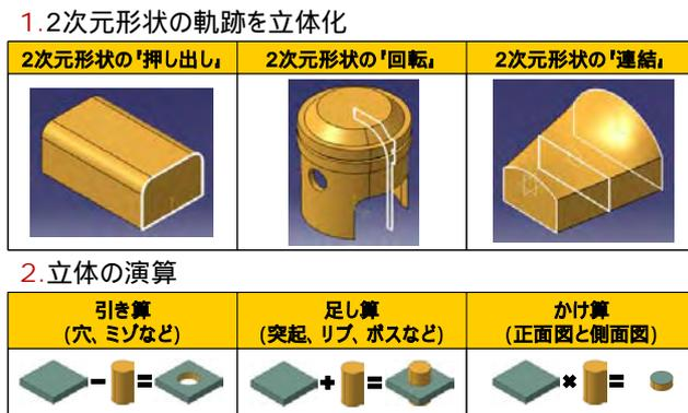
図7に、ソリッドモデリング作成の一例を示しているが、ここでも示唆されるように、今日の3D CAD は分業化及び個々に完結したプロセスを前提としており、確定した部品形状を厳密にモデル化しなければならない。
